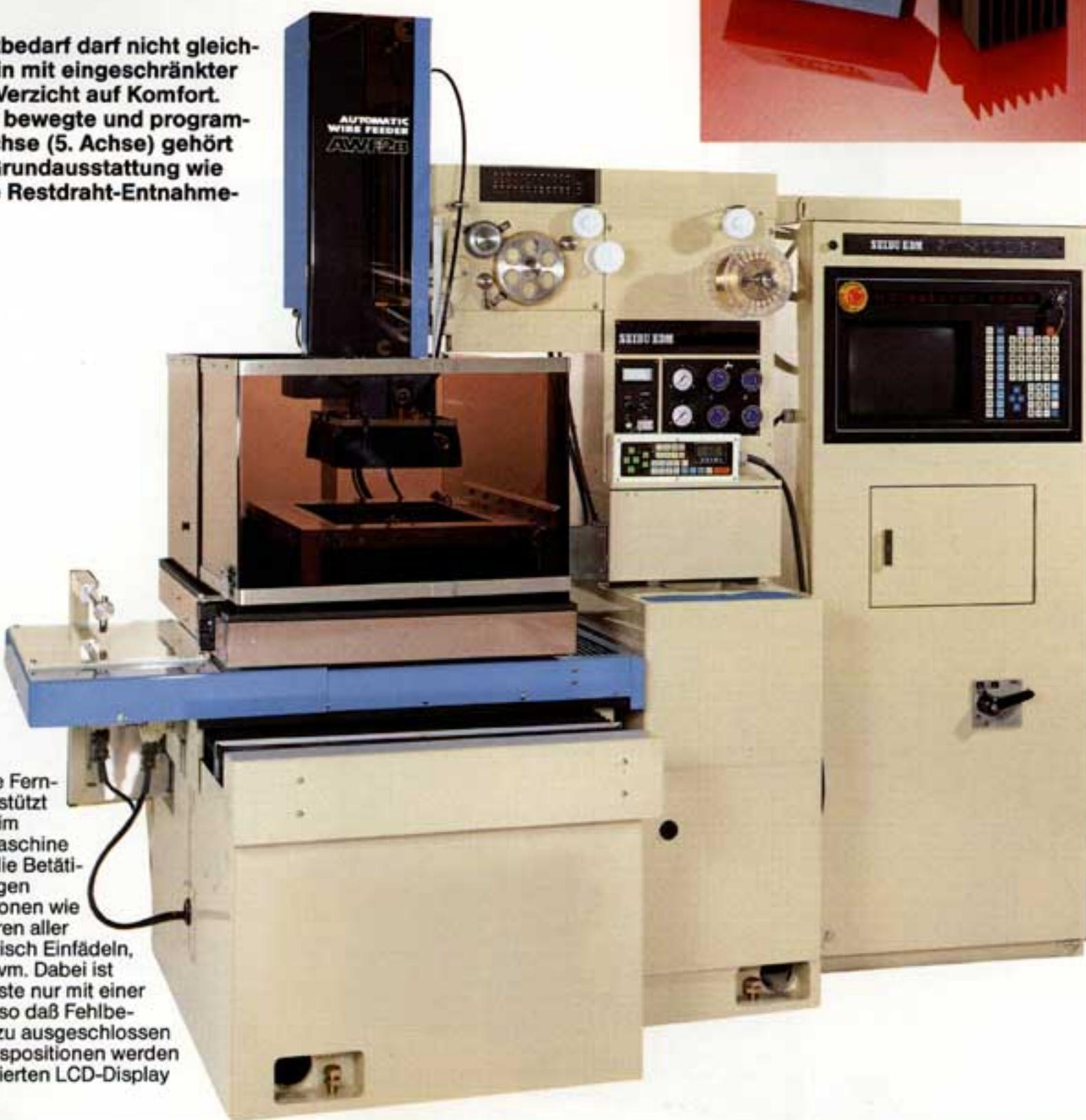
Die serienmäßige Fernbedienung unterstützt Ihre Bediener beim Einrichten der Maschine und ermöglicht die Betätigung aller wichtigen Maschinenfunktionen wie Antasten, Verfahren aller Achsen, automatisch Einfädeln, Programmstart uvm. Dabei ist jede Funktionstaste nur mit einer Funktion belegt, so daß Fehlbedienungen nahezu ausgeschlossen werden. Alle Achspositionen werden zudem am integrierten LCD-Display angezeigt.
