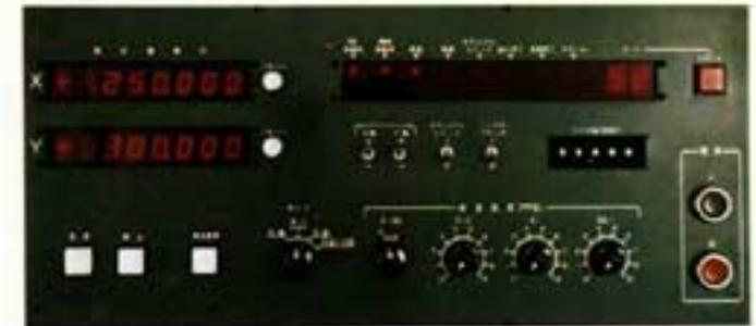
Die digitale Anzeige der X/Y-Koordinaten erfolgt simultan. Überprüfung der Position ist in jeder Stellung möglich, dies ist unentbehrlich beim Einrichten.
