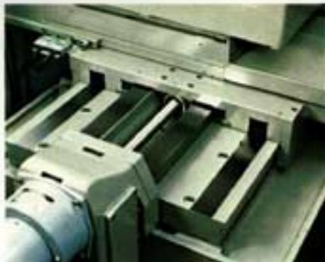
Sicherheitsausführungen durch Tisch-Isolation und Draht-Erdung. Selbst, wenn der Draht zufällig berührt wird, besteht keine Unfallgefahr.
